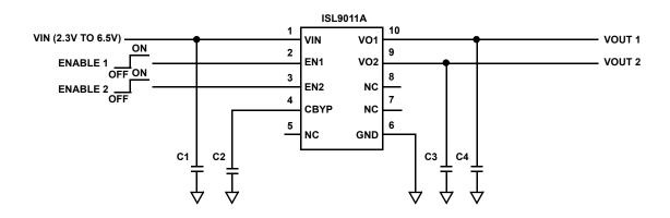
C1, C3, C4: 1µF X5R CERAMIC CAPACITOR C2: 0.1µF X5R CERAMIC CAPACITOR
