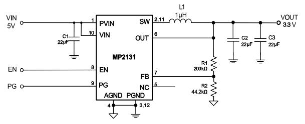
Figure 7—5V<sub>IN</sub>, 3.3 V/4 A
