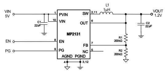
Figure 6—5V<sub>IN</sub>, 1.2 V/4 A
