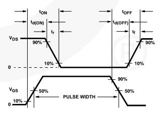
FIGURE 19. RESISTIVE SWITCHING WAVEFORMS
