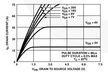
FIGURE 7. SATURATION CHARACTERISTICS
