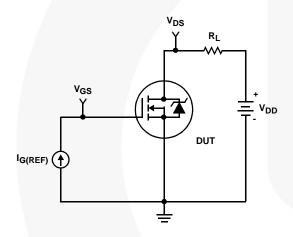
FIGURE 16. GATE CHARGE TEST CIRCUIT
