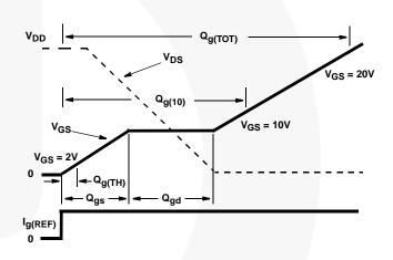
FIGURE 17. GATE CHARGE WAVEFORM
