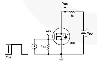
FIGURE 18. SWITCHING TIME TEST CIRCUIT
